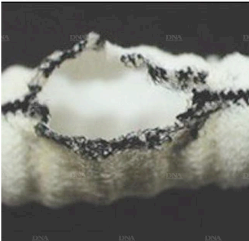
Exemple de prothèse qui s'est déchirée avec le temps : expertiser ce type de défaillance vise à améliorer la fiabilité des implants posés dans les vaisseaux sanguins. (Doc remis)
